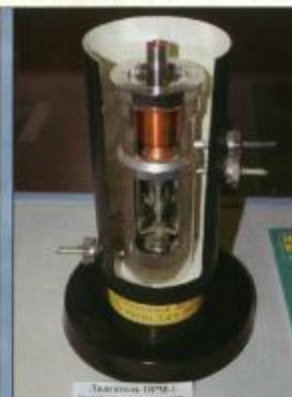
б) двигатель ORM-1 предназначался для стендовых исследований внутрикамерных процессов.
